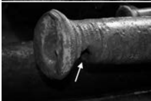
A frecha amosa a parte danada do tubo do canón 2 con perda de material e perforación na boca. Fonte: Arquivo do autor
